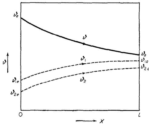
ABB. 5. Gleich-Gleichstrom.
